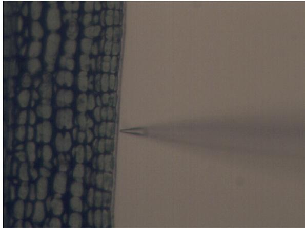
4、打开显微镜灯光，调高光源亮度，再次检测叶片同一位点的表面氧分子流速。
