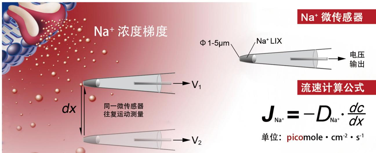
以测量细胞外的Na<sup>+</sup>浓度梯度为例，说明其基本的工作原理。Na<sup>+</sup>微传感器通过前端灌充的液态离子交换剂（Liquid Ion eXchanger, LIX）实现Na<sup>+</sup>的选择性检测。该微传感器尖端开口通常为1-5微米，在Na<sup>+</sup>浓度梯度中已知距离dx进行0.3Hz频率的两点往复测量，分别获得电压V1和V2。两点间的浓度差dc则可以从V1、V2及已知的该微传感器的电压/浓度校正曲线(基于Nernst方程)计算获得。D是Na<sup>+</sup>离子的扩散常数(单位：cm·sec)，将它们代入Fick第一扩散定律公式 $J = -D \cdot dc/dx$ ，可获得该离子的流动速率，mol·cm·s，即：每秒钟通过每平方厘米的该离子分子的摩尔数。
